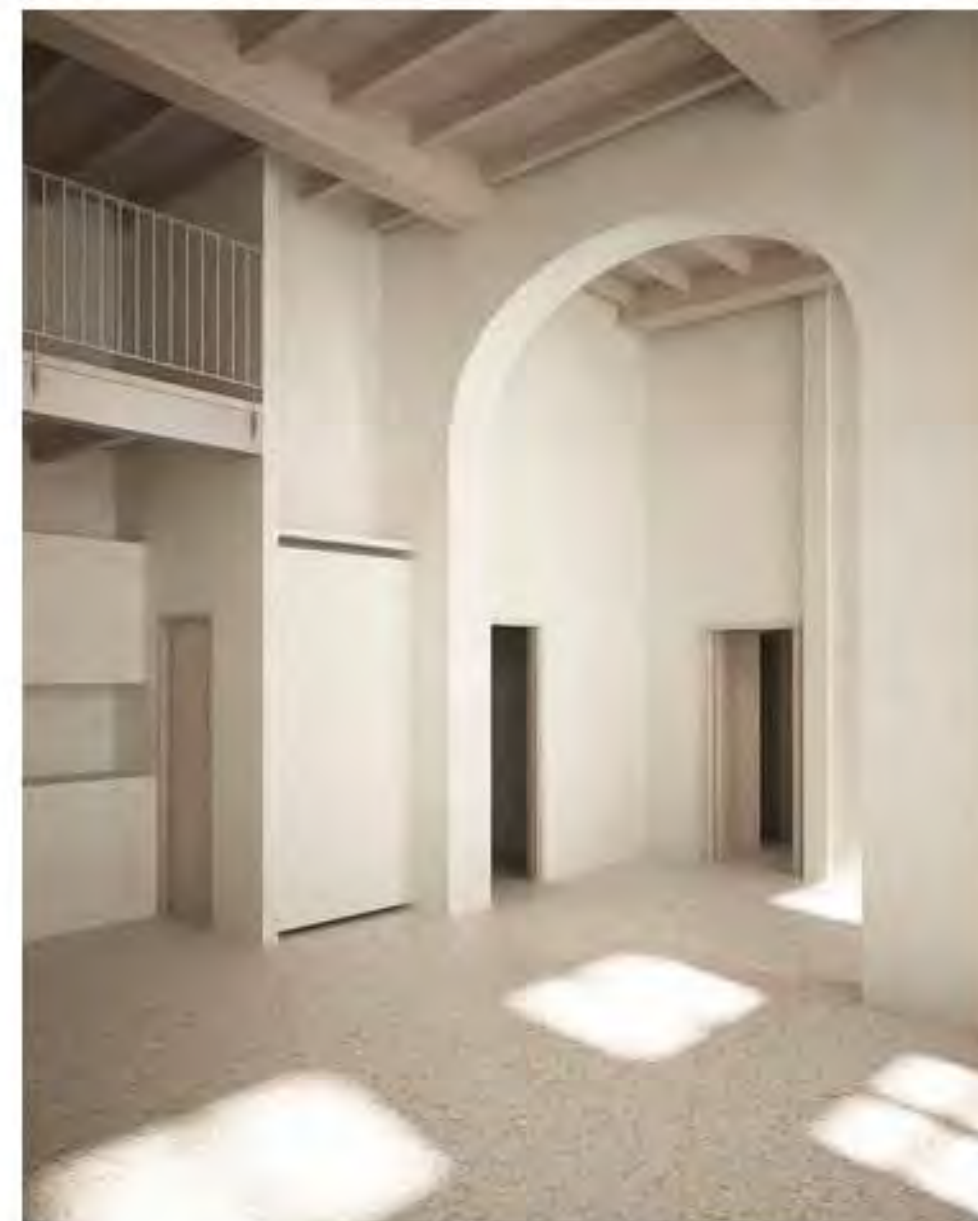
Render di progetto dell'intervento previsto nell'appartamento D3: l'altezza degli spazi viene enfatizzata da un parziale soppello, i sale storici in legno vengono lasciati a vista.
