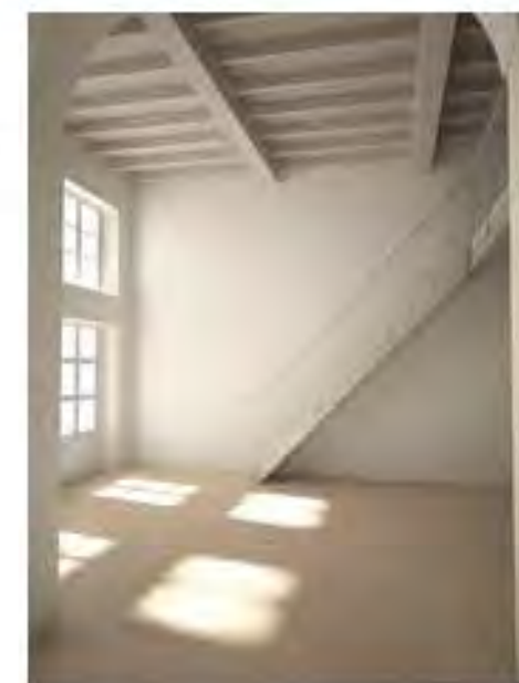
Render di progetto dell'intervento previsto nell'appartamento D3: l'altezza degli spazi viene enfatizzata da un parziale soppello, i sale storici in legno vengono lasciati a vista.
